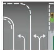
Marca longitudinal discontinua de guía en intersección
