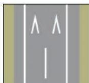
Marca de separación de seguridad entre vehículos
